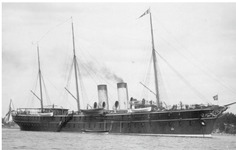
Яхта «Полярная Звезда», до 1914 года, фотограф К. Булла. Размеры: длина – 106,5 м, ширина 13,8 м, осадка 5,2 м. Скорость хода 17 узлов. Вооружение 447 мм пушки Гочкиса. Экипаж – 349 человек, 50 человек прислуги.
